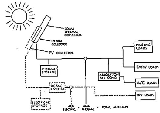
(d) Absorption Cooling Hybrid Solar Power System
